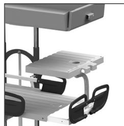
Figure 15 Démontage de la plaque de couchage et du matelas.
