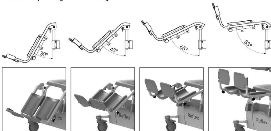
Figure 9 à 12 Possibilité de réglage angle d'assise.
