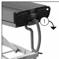
Figure 13 Drainage de l'eau.
