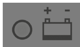
Figure 27 Indication du niveau de la batterie sur la commande.
